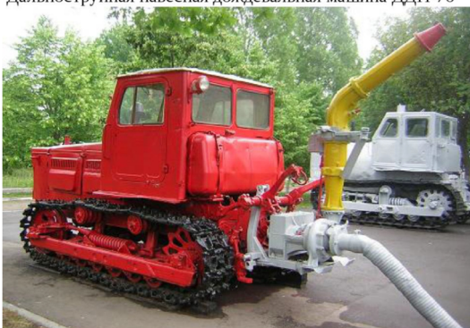
Дальнеструйная навесная дождевальная машина ДДН-70
